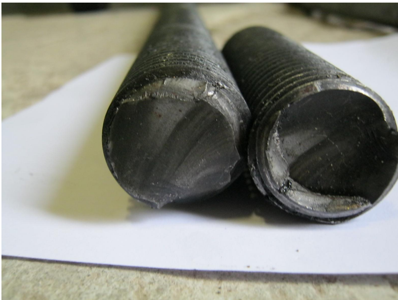
Figur 2: Mølle 6 Knækkede gevindstænger.
